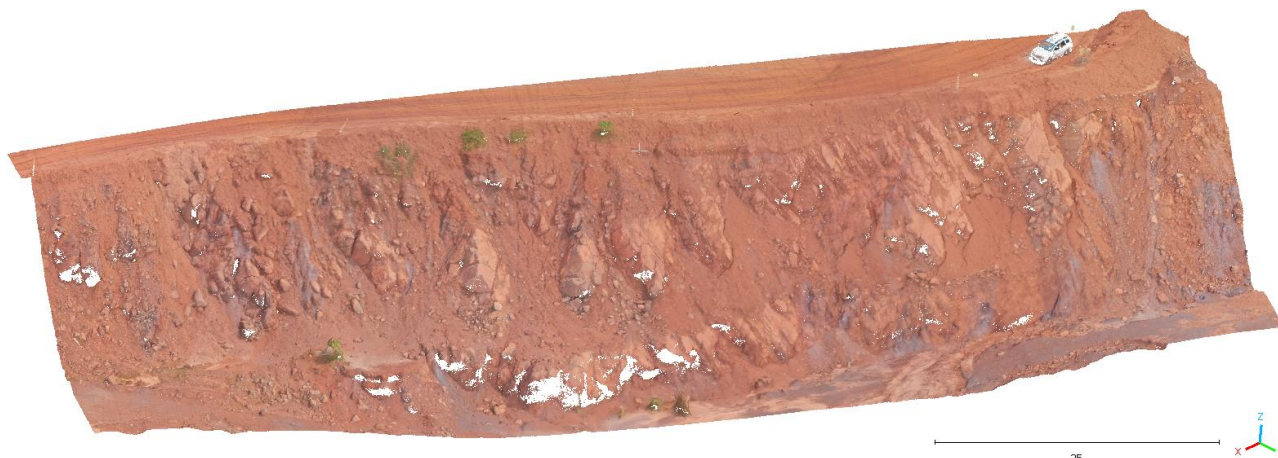
Figura 1. Nuvem de pontos tridimensional de um talude rochoso.
