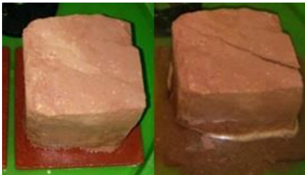
Figura 8 - Ensaio de desagregação para o SR (LEITE, 2016).
