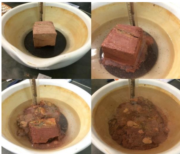
Figura 10 - Ensaio de desagregação para o P3 (VIEIRA, 2017).
