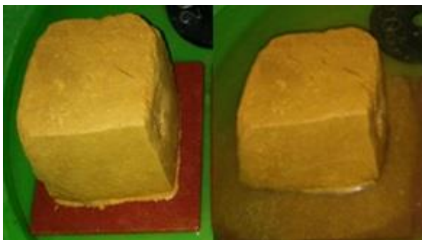
Figura 9 - Ensaio de desagregação para o SA (LEITE, 2016).
