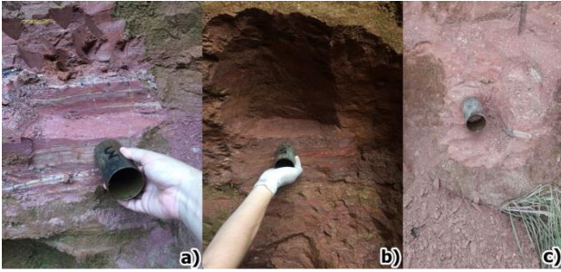
Figura 3. Coleta de amostras para o ensaio de Pinhole: a)P3 b)P4 e c)P5.
